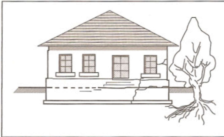
Désordres partiels dus à l'action localisée d'un arbre
