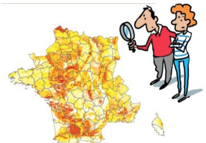
Exposition : Cette **cartographie** définit différentes zones en fonction de leur degré d'exposition au phénomène de mouvement de terrain différentiel consécutif à la sécheresse et à la réhydratation des sols argileux.
