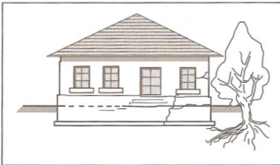
Désordres partiels dûs à l'action localisée d'un arbre
